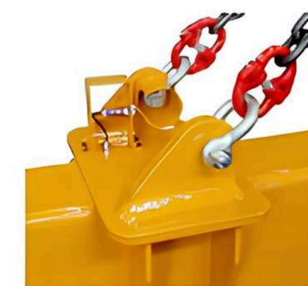
индуктивный бесконтактный датчик натяжения цепных строп предотвращает отключение магнитов в процессе перемещения груза
